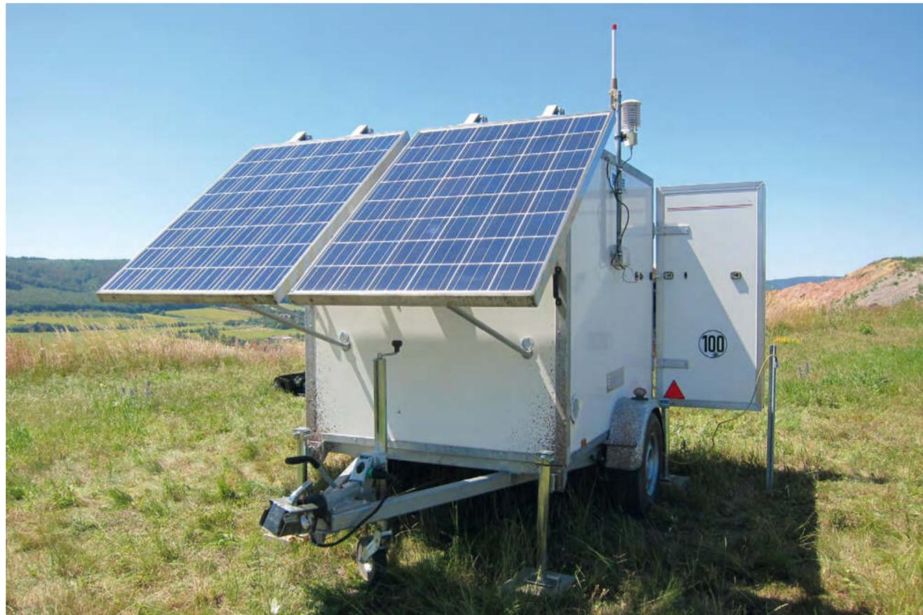
LiDAR-Messgerät – Fotos aus anderen ABO Wind-Projekten
