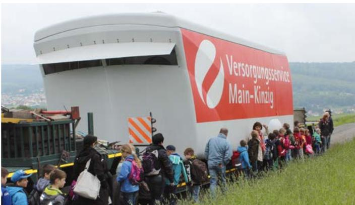
Das Maschinenhaus ist auf dem Weg zur Baustelle. In ihm verbirgt sich das Herz der Anlage mit Antriebswelle, Getriebe, Generator und Steuerung. Wie der Wind in sauberen Strom verwandelt wird, zeigt das Schema.
