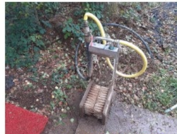
Brosse pour laver des hottes et exemple de voie de circulation pour pré-démontage des hottes
