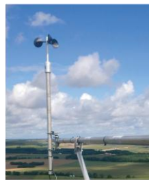
Anémomètre Mesure la vitesse et la pression du vent
