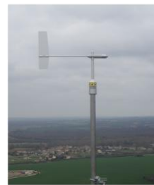
Girouette Mesure les directions du vent
