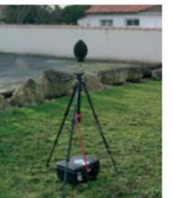
Une **seconde campagne de mesures acoustiques** est réalisée une fois le parc éolien construit et en fonctionnement. Elle permet de contrôler, par des mesures aux mêmes emplacements, que le parc est bien en conformité au niveau acoustique.
