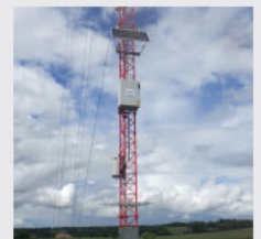
Coffret data logger Enregistre et transmet les données mesurées
