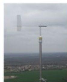
Girouette Mesure les directions du vent
